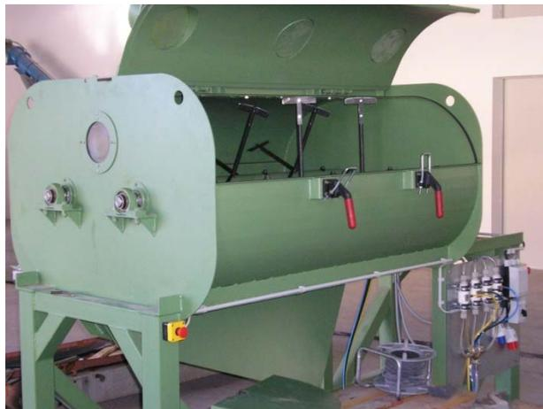
Fig. 3: Beleimmischer, Pilotanlage des Leibniz-Instituts für Agrartechnik Potsdam-Bornim e. V. (ATB)
